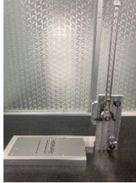
Hình 6.3: Cơ cấu cân bằng trọng lực
